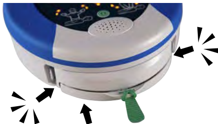
Figur 4. Isættelse af en Pad-Pak
