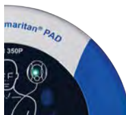
Figur 11. Blinkende grøn LED; ingen handling påkrævet.
