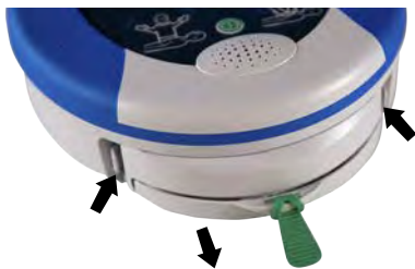
Figur 8. Frakobling af Pad-Pak
