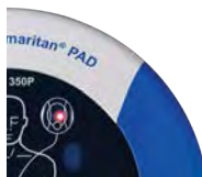
Figur 10. Blinkende rødt lys og/eller bippen. Se Fejlfinding i bilag B.
